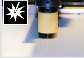
Laserpointer zur optischen Anzeige der Werkzeugmitte
