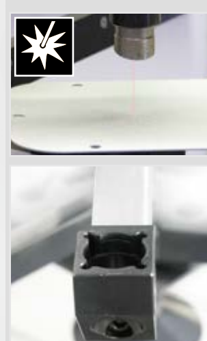
Laserpointer zur optischen Anzeige der Werkzeugmitte + Powerbank
